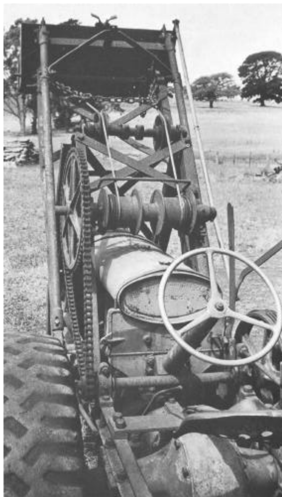
Fig. 4 - Trasmissioni non protette, su un trattore operante durante la seconda guerra mondiale
