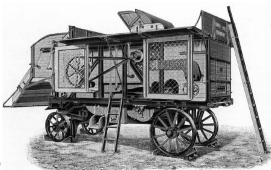
Fig. 1 - Trebbiatrice con dispositivi di sicurezza, presentata alla mostra DLG del 1894
