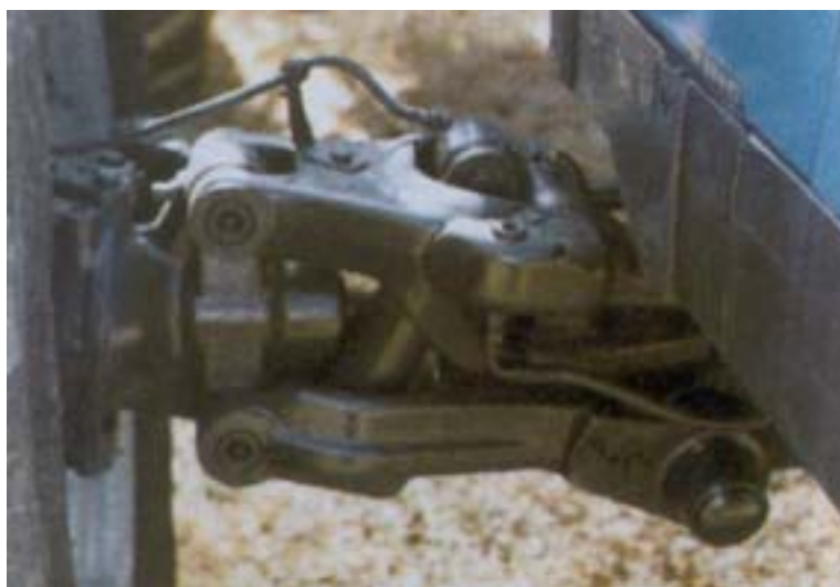
Fig. 4 – La soluzione Landini per la sospensione dell'assale anteriore a ruote indipendenti.
