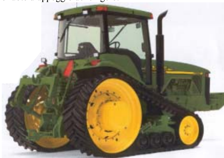
Fig. 5 – Trattrice John Deere 8010T (160-220 kW), equipaggiata con cingoli in gomma di larghezza massima fino a 0,76 m. Velocità massima 30 km/h.
