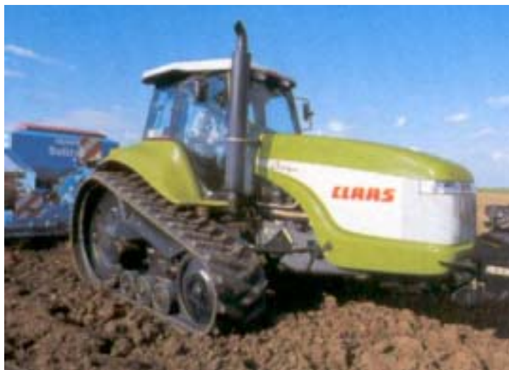
Fig. 6 – Claas Challenger (10 t, 150-200 kW). La cingolatura in gomma fornisce una superficie di contatto col suolo fino a 3,5 m 2 .
